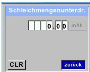
Die Schleichmengenunterdrückung kommt in Anwendung um Verbrauchswerte unterhalb des definierten „LowFlow Cut off“ Wertes als  $0 \text{ m}^3/\text{h}$  anzuzeigen und auch nicht zum Verbrauchzählerstand zu addieren.
